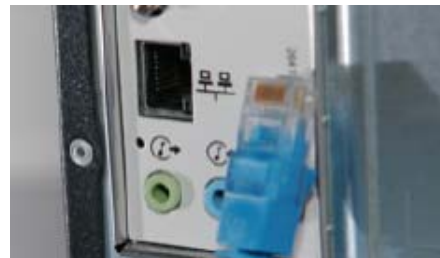
Nätverkskortets uttag och nätverkskabel kontakt RJ45
