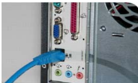
Inkopplad nätverkskabel i nätverkskortet
